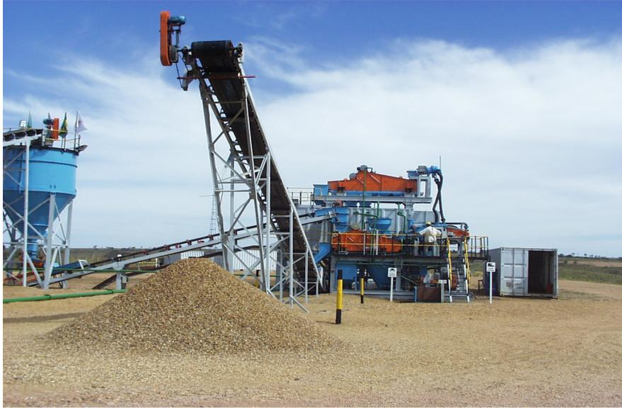
Figura 56. Planta de Meio Denso (parte do DMS) para 30 m<sup>3</sup>/hora, em amostragem aluvionar - SAMSUL Mineração (Foto Mario Freitas)
