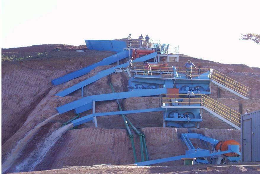
Figura 54. Planta aluvionar para 30 m<sup>3</sup>/hora da SAMSUL Mineração com jigues e mesas de graxa em Coromandel MG. (Foto Mario Freitas)
