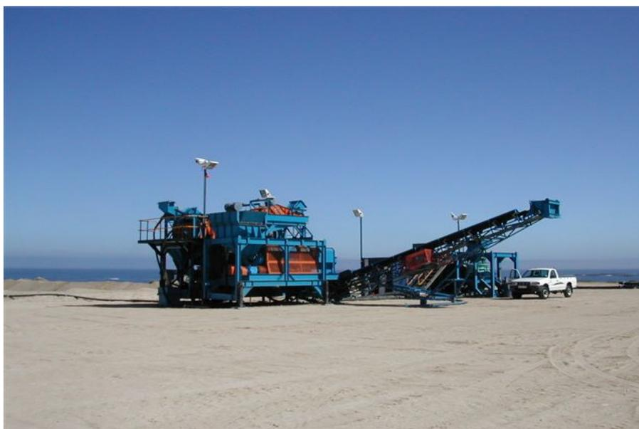
Figura 45. Planta de Meio Denso com capacidade de 25 toneladas/hora para Cascalhos na Namíbia.
