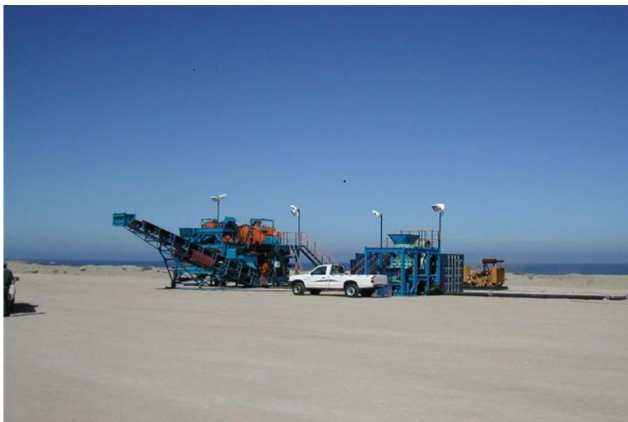
Figura 44. Planta de Meio Denso com capacidade de 25 toneladas/hora para Cascalhos na Namíbia.
