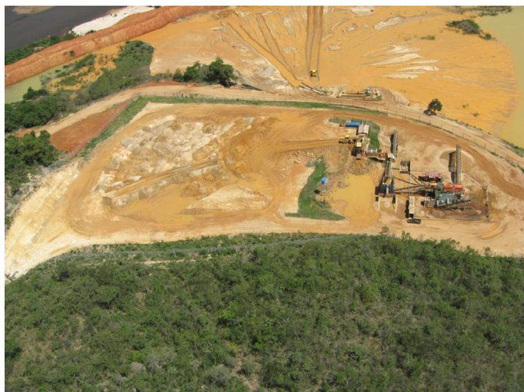
Figura 17. Detalhe da Planta de Tratamento da Mina de Peçanha (RST), localizada na margem direita do rio Jequitinhonha em Diamantina (MG). Capacidade de 90 ton/hora. (foto Garnett, Masun e Jellicoe 2008).
