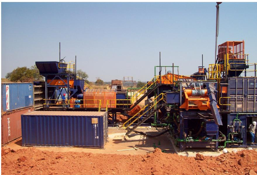
Figura 47. Planta para kimberlito com capacidade de 30m<sup>3</sup>/hora, instalada na África (ADP PROJECTS)
