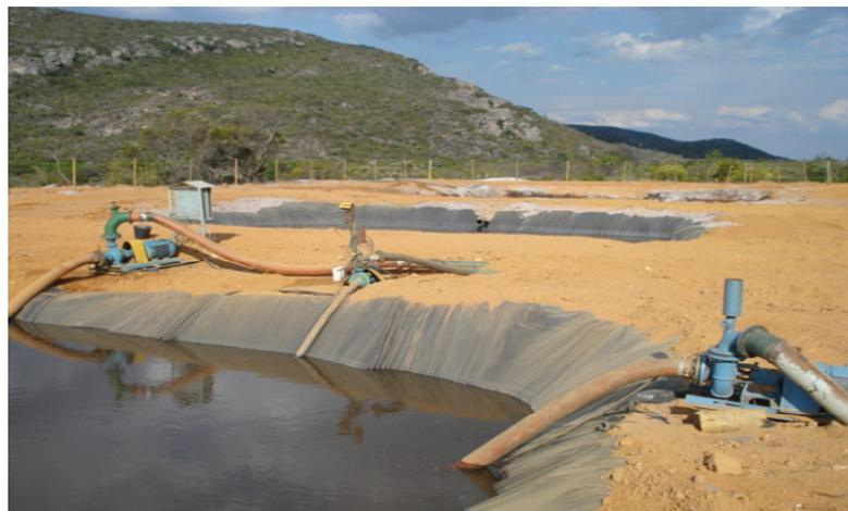
Figura 36. Bombas de recalque para utilização da água no processo (Foto SAMSUL - Bahia 2008)
