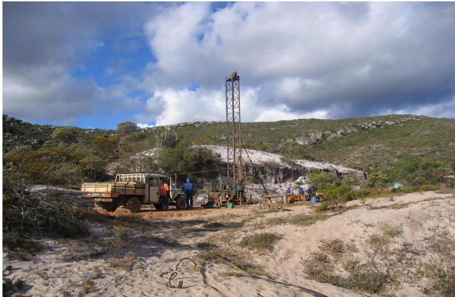
Figura 67. Sonda Rotativa de 6" fazendo furo em rocha kimberlítica na Bahia. (Foto Mario Freitas)
