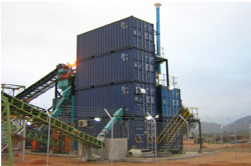
Figura 51. Planta de Apuração (Separação) final com sistema eletrônico, mesas de graxa e mesas de luvas tudo em contêiner (ADP PROJECTS)
