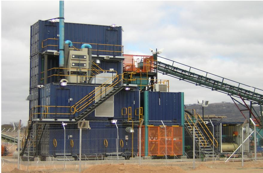
Figura 50. Planta de Apuração (Separação) final com sistema eletrônico, mesas de graxa e mesas de luvas tudo em contêiner (ADP PROJECTS)
