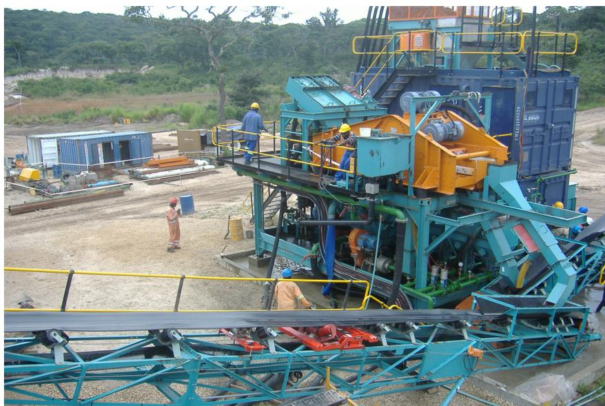
Figura 49. Planta de DMS para 10 toneladas/hora de concentrado oriundo do Pré-tratamento (ADP PROJECTS)
