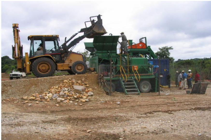
Figura 59. Planta Móvel de jiges em contêiner para amostragens aluvionares na
