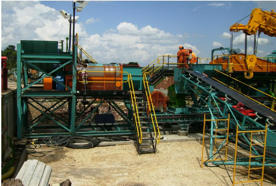
Figura 46. Planta para kimberlito com capacidade de 30m<sup>3</sup>/hora, instalada na África (ADP PROJECTS)
