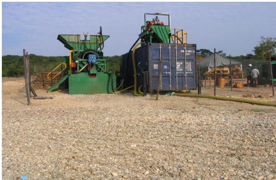
Figura 61. Planta Móvel de jigues em contêiner para amostragens aluvionares na África. (ADP PROJECTS)
