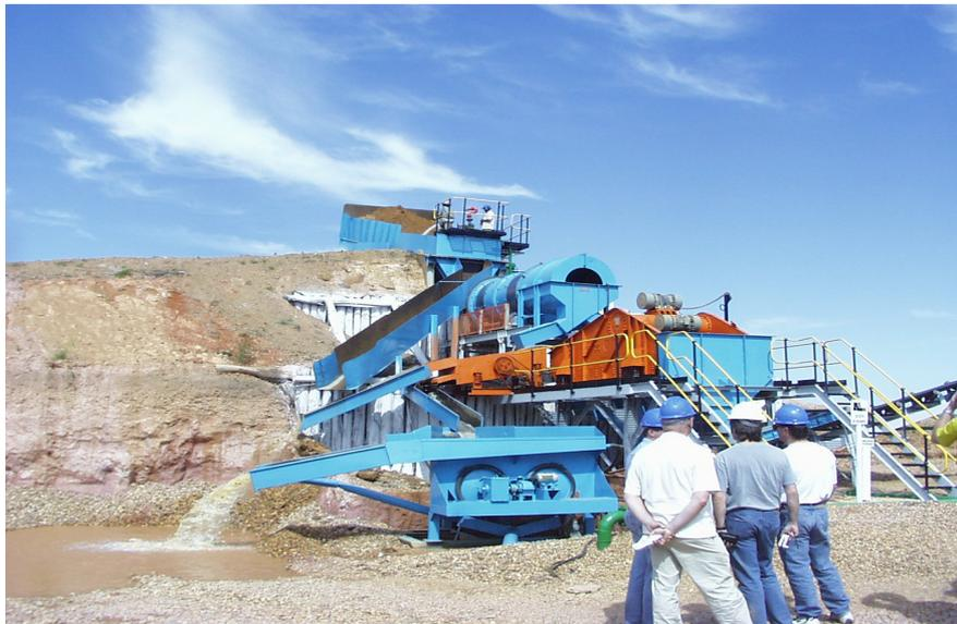
Figura 55. Planta de Meio Denso (parte do pré-tratamento) para 30 m<sup>3</sup>/hora, em amostragem aluvionar - SAMSUL Mineração (Foto Mario Freitas)
