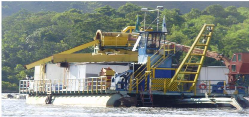
Figura 27. Balsa da Mineração Tibagiana com capacidade de sucção de 3.600 m<sup>3</sup> de cascalho por mês, no leito do Rio Tibagi. (Fonte Mineração Tibagiana)
