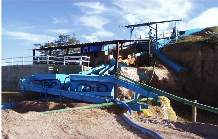
Figura 52. Planta Tipo Garimpo com capacidade de  $10\text{m}^3/\text{hora}$  com jiges tipo Yuba trapezoidais
