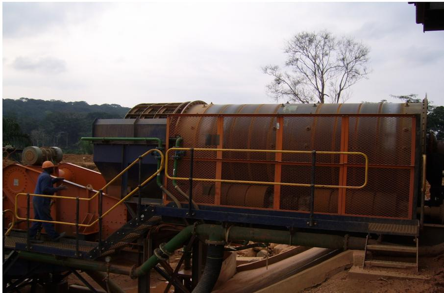
Figura 57. Planta de Pré-tratamento na África para 100 m<sup>3</sup> /hora. (ADP PROJECTS)
