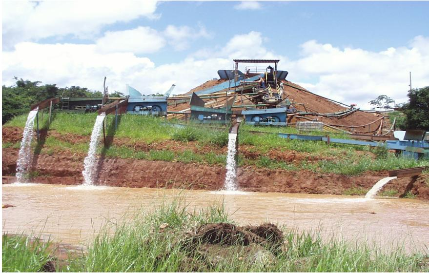
Figura 62. Planta de jigsawes para 50m<sup>3</sup>/hora montada em MG pertencente à Mineração do Sul.
