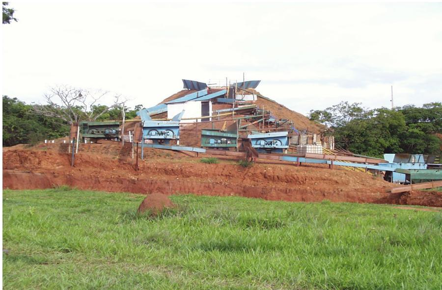
Figura 63. Planta de jigsawes para 50m<sup>3</sup>/hora montada em MG pertencente à Mineração do Sul.
