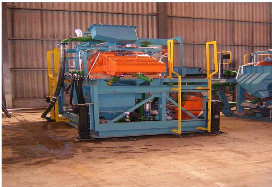
Figura 48. Planta de DMS para 05 toneladas/hora de concentrado oriundo do Pré-tratamento (ADP PROJECTS)
