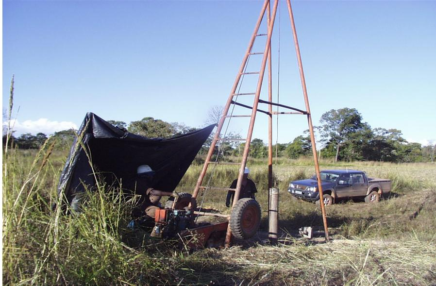
Figura 66. Sonda de Percussão em Operação para avaliação de cascalhos diamantíferos aluvionares em Coromandel MG. (Foto Mario Freitas)
