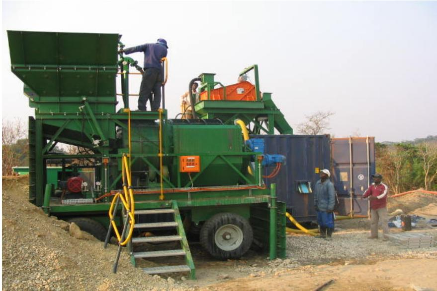
Figura 60. Planta Móvel de jigues em contêiner para amostragens aluvionares na África. (ADP PROJECTS)
