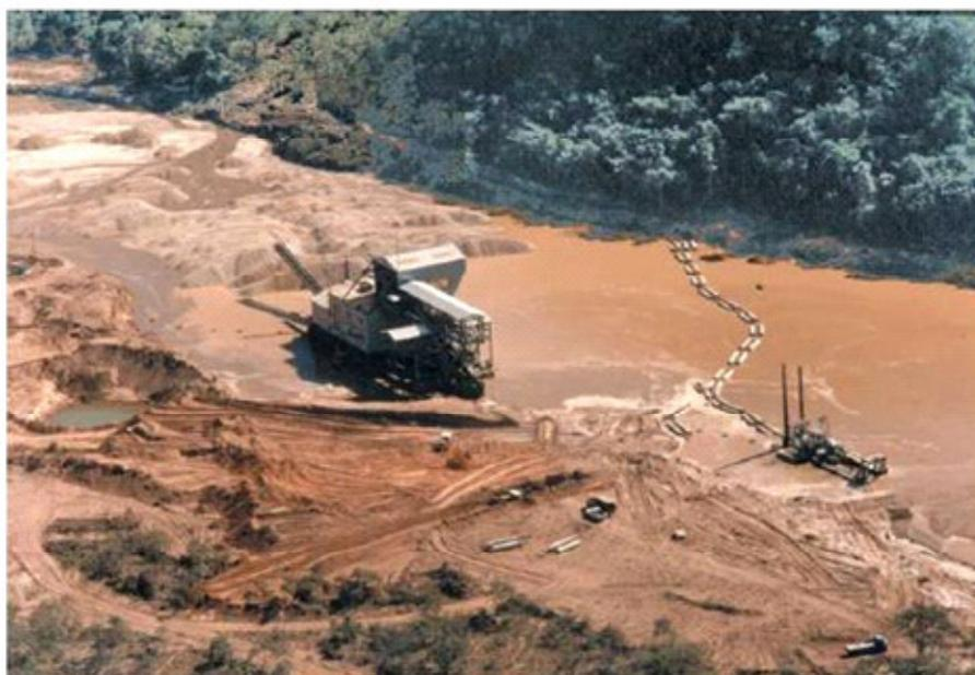
Figura 15. Draga de alcatruz (à esquerda), seguida por draga de sucção (à direita). Mineração Rio Novo, em um depósito aluvionar localizado no médio rio Jequitinhonha (foto Chaves & Chambel, 2004)
